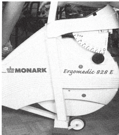
شکل E-۱ برد مقیاس، پاندول و چرخ یک دوچرخه کارسنج.
